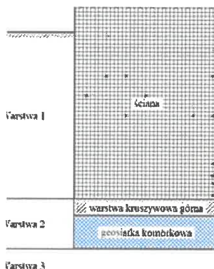
Rys. 2 Wzmocnienie podłoża (fundament) pod grunt zbrojony geosiatkami
